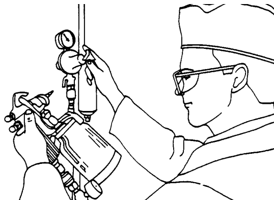
Figure 3.1.26 Réglage de la pression d'air (DGEA)
