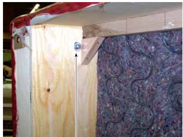
Fixation des accoudoirs à l'aide d'un écrou
