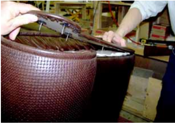
Figures 3.3.4 Fixation de l'appliqué
